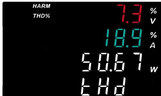
窗口 4 显示项可以为 “tHD” 或 “or01” ~ “or50”。 “tHD” 表示总谐波失真，“or01” ~ “or50” 表示当前选择的谐波次数。窗口 4 显示项可以通过【▲】或【▼】键切换，【▲】或【▼】键支持连接功能，长按这两个按键可快速切换显示项。
