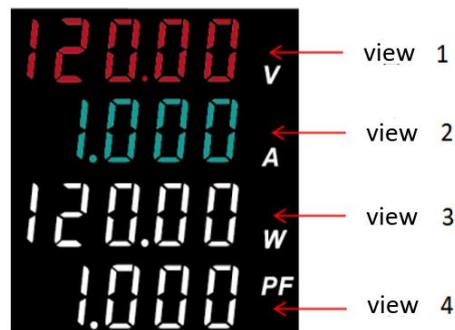
UTE9806+每个显示窗口可以显示不同的测量参数，每个窗口显示的参数均可切换，如下表所示，“√”表示该窗口能测量该参数，“/”表示该窗口不支持显示该参数）。
