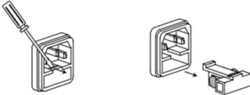
如果保险丝已经熔断，请根据机型选择相同规格的保险丝进行替换，保险丝与机型配套信息如下表所示。
